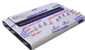
Slika 22: Brajčno računalo Esytime Evolution
